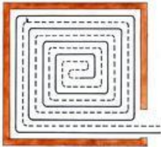
Spiralne prowadzenie instalacji ogrzewania podłogowego
