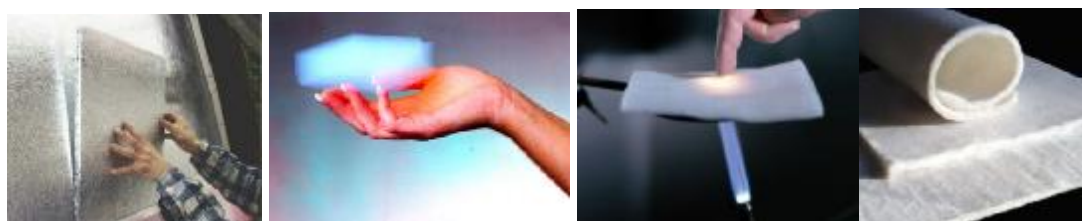
Rysunek 0-10 Od lewej do prawej: lepsza izolacja dzięki materiałom na bazie aerożeli; aerożel: opróżnione nanopory w matrycy \text{SiO}_2 38 ; elastyczny nanoporowaty materiał izolacyjny firmy Insulcon B.V. (2x)
